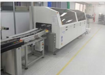
Yüksek teknoloji Bölgesel Lehimleme makinesi ile delikiçi malzemelerinizi azotlu ortamda, sıfır hata ve yeniden işlem gerektirmeden en yüksek standartlarda üretim yapılmaktadır.
